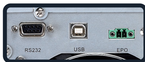
Puertos de comunicaciones externas / apagado de emergencia
